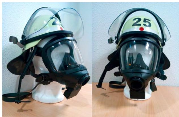
In Atemschutzmaske integriertes Display des Projektes Celidon (IFR, WHZ)
